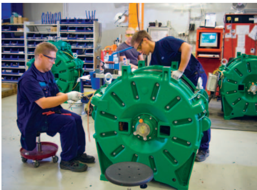
KONE EcoDisc® -nostokoneisto ei sisällä lainkaan öljyä.
